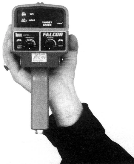
SLIKA 2: MJERILO BRZINE FALCON – pogled na pokaznik i na upravljački dio mjerila
